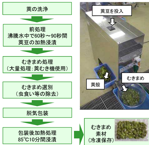
図3 黒大豆エダマメのむきまめ加工工程
